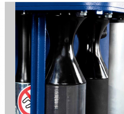
Doppel - motorisches Folienvordehnungssystem, von 1580 - 400% Folienvorreckung. Über das Touchpanel regelbar. Absolut gleichmäßiger und produktschonender Folienauftrag durch das integrierte Foliendehnsystem.
